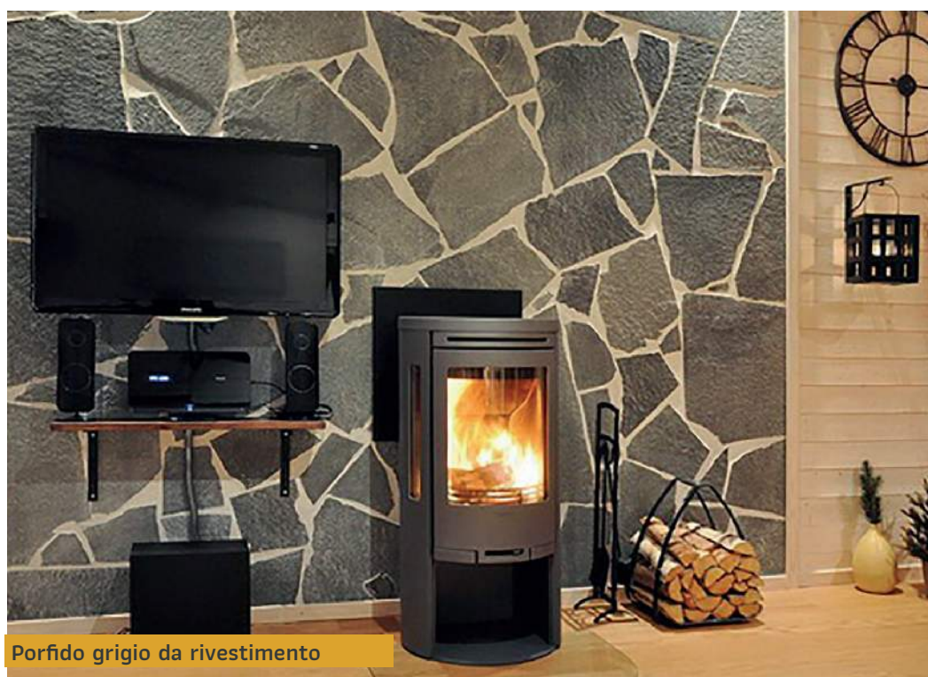
Porfido Grigio-viola - Montaggio opera incerta lati segati con fuga calibrata a 1 cm
